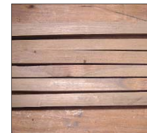
I listelli di bambù prima e dopo il trattamento e la spianatura.
