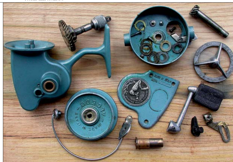
Esploso dell'Alcedo Omnia De Luxe. In basso: particolare dell'interno dell'Alcedo Omnia Minor.
